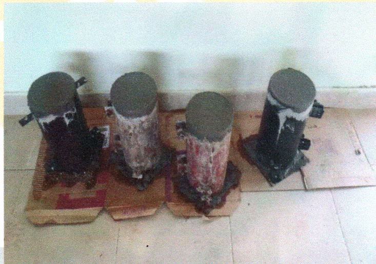
Fotografía 32 Toma de muestras de concreto
