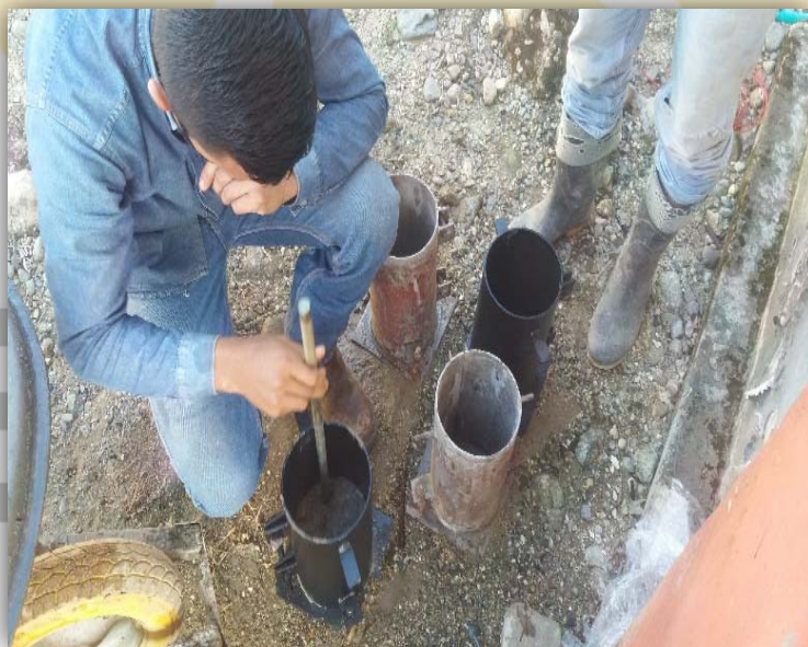
Fotografía 30 Toma de muestras de concreto
