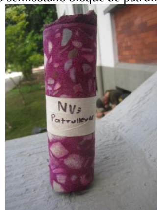
FOTOGRAFIA no. 110. Extracción de núcleo en viga eje B 5-6 piso 2 bloque de patrulleros.
