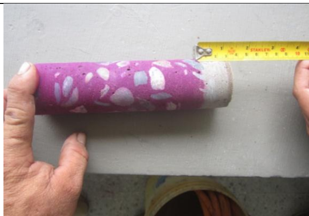
FOTOGRAFIA no. 80. Extracción de núcleo en Columna eje C7 piso 2 zona administrativa.
