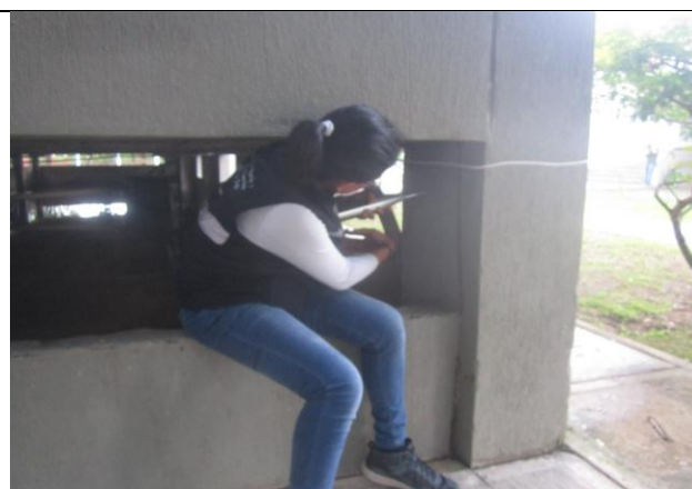
FOTOGRAFIA no. 71 Ensayo de esclerometría columna eje C1 bloque de patrulleros.
