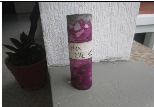
FOTOGRAFIA no. 82. Extracción de núcleo en Viga entrepiso 2-3 eje 4-5 zona administrativa.
