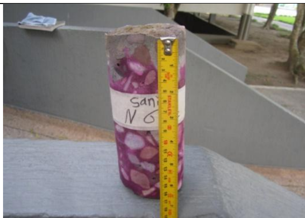
FOTOGRAFIA no. 86 Extracción de núcleo en Viga eje G 2i-3i piso 1 zona administrativa.
