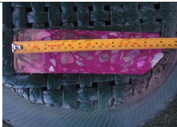
FOTOGRAFIA no. 102. Extracción de núcleo en viga eje B 10-11 semisótano bloque de oficiales.
