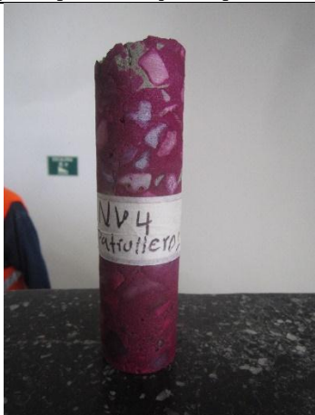
FOTOGRAFIA no 113. Extracción de núcleo en columna eje B3 piso 2 bloque de patrulleros.
