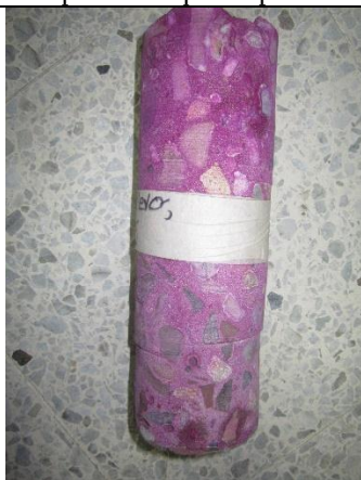
FOTOGRAFIA no. 115. Extracción de núcleo en columna eje 1 B-C piso 1 bloque de patrulleros.
