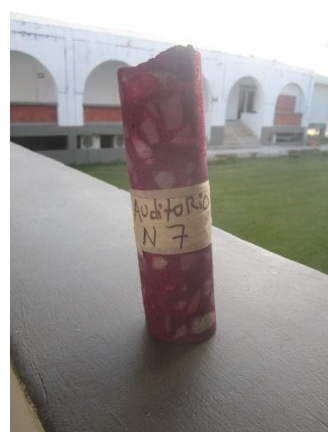
FOTOGRAFIA no. 94. Extracción de núcleo en columna eje C10 piso 1 bloque de oficiales.
