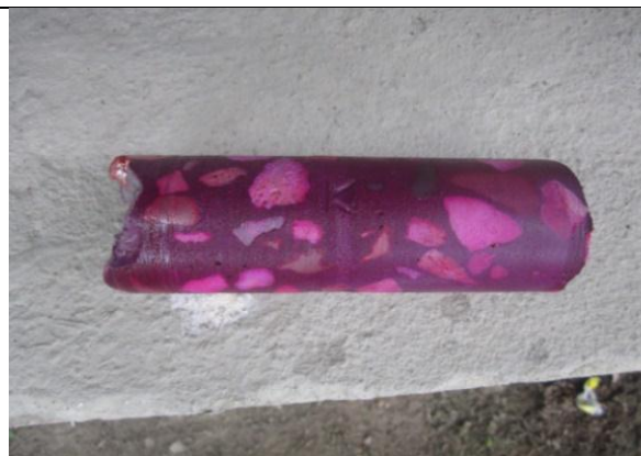
FOTOGRAFIA no. 77. Extracción de núcleo en columna eje K-6I semisótano bloque de administración.
