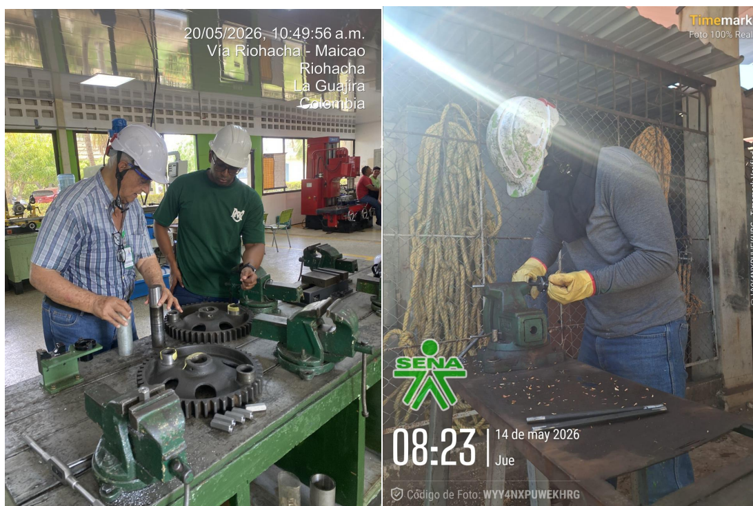
Figura 2. Actividades de inspección dimensional, ajuste y fabricación de piezas mecánicas para molinos de viento en el taller del CIEA.
