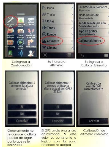
Imagen 2 Calibración de altímetro.
