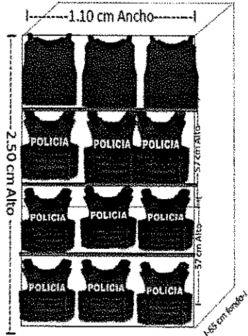
Rack con capacidad de almacenar 200 elementos balísticos
