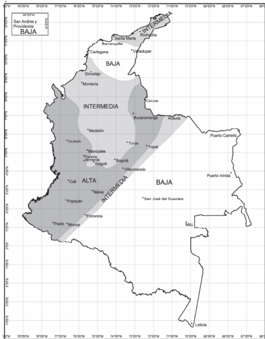
Figura 19. Zonas de amenaza sísmica. Tomado de (NSR-10, 2012).
