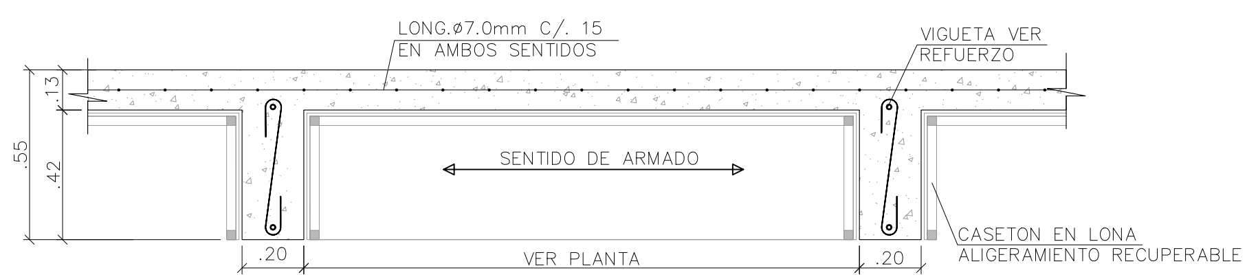
DT-03 PLACA ALIGERADA H=55cm ESC 1:20
