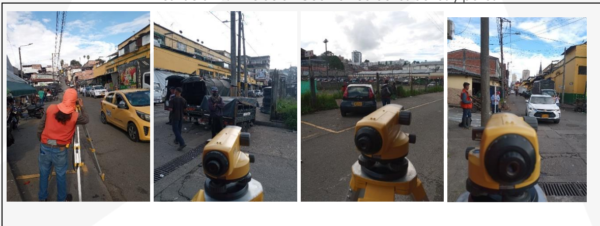
Ilustración 9. Nivelación Geométrica de los deltas y pozos
