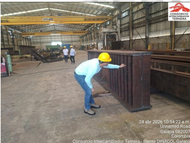
Ilustración 23. Visita a sitio de fabricación de la estructura metálica del puente en el municipio de Galapa (Atlántico) – 24 de abril de 2026
