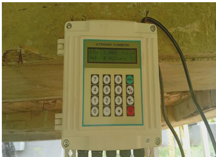
Foto 2. Segunda lectura de la unidad transmisora: Flow: 2,1882 l/s; Vel: 0,4623 m/s. Equipo en operación continua y estable. (CABP, Marzo 2026)
