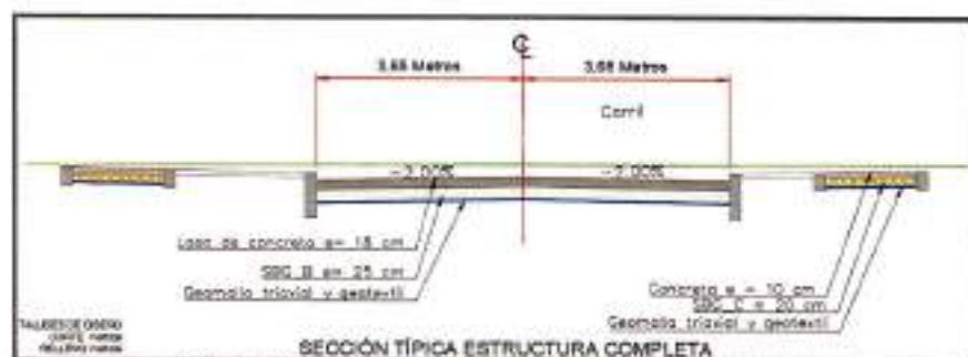
IMAGEN 5. ESTRUCTURA DEL PAVIMENTO.
