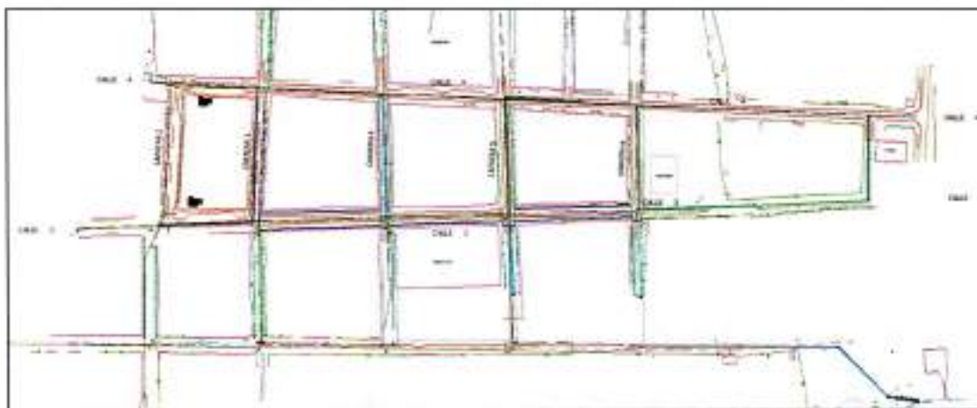
IMAGEN 2. RED ALCANTARILLADO PLUVIAL.
