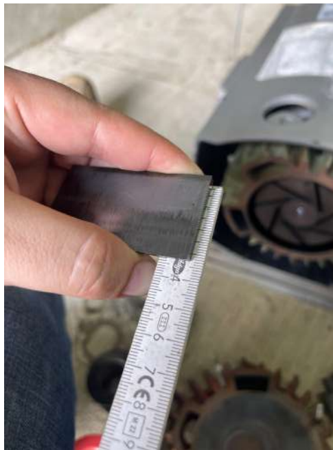
Imagen 30. Verificación de desgaste de paletas de carbono. Resultado 32mm. (Deben medir mínimo 28 mm).
