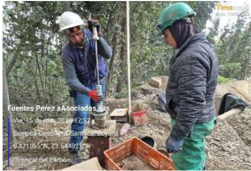
toma de muestra, briquetas primera capa.
