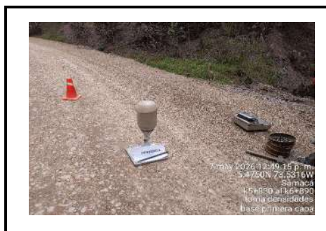
k8+240 a k8+400, toma contramuestra densidades sub base granular
