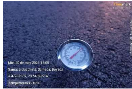
k9+070, seguimiento y control temperatura mezcla asfáltica segunda capa.
