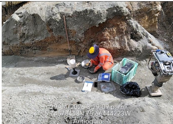
Fotografía 11 Toma de ensayos de densidades en campo 29/4/2026
