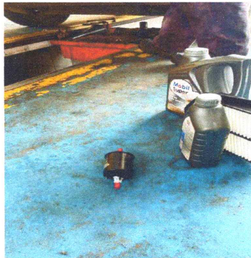
SUMINISTRO FILTRO COMBUSTIBLE
