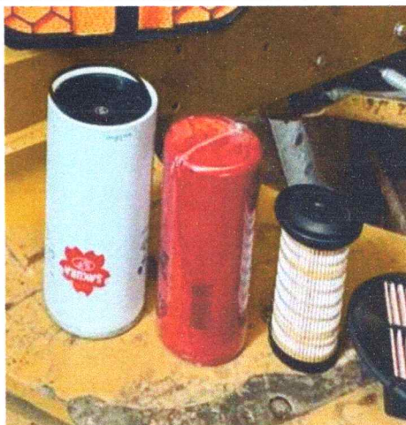
SUMINISTRO FILTRO COMBUSTIBLE 360-8960
