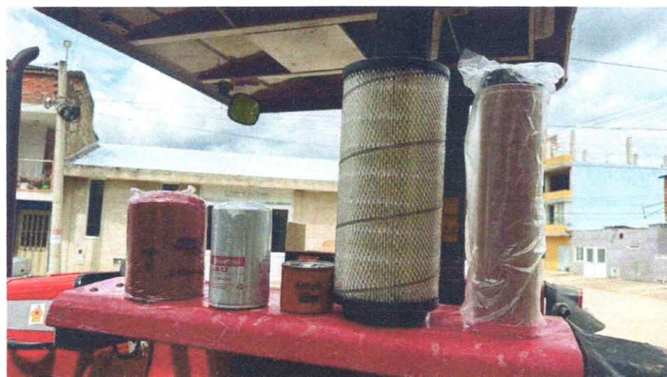
SUMINISTRO FILTRO DE AIRE INTERNO
