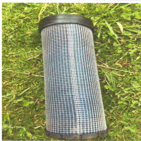
SUMINISTRO FILTRO DE AIRE PRIMARIO
