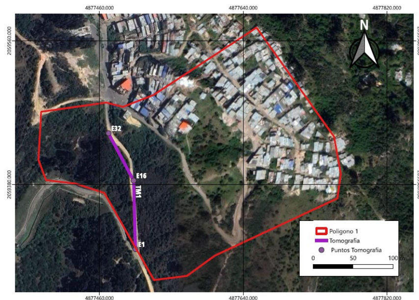
Figura 60. localización de tomografías de resistividad eléctrica polígono 1
