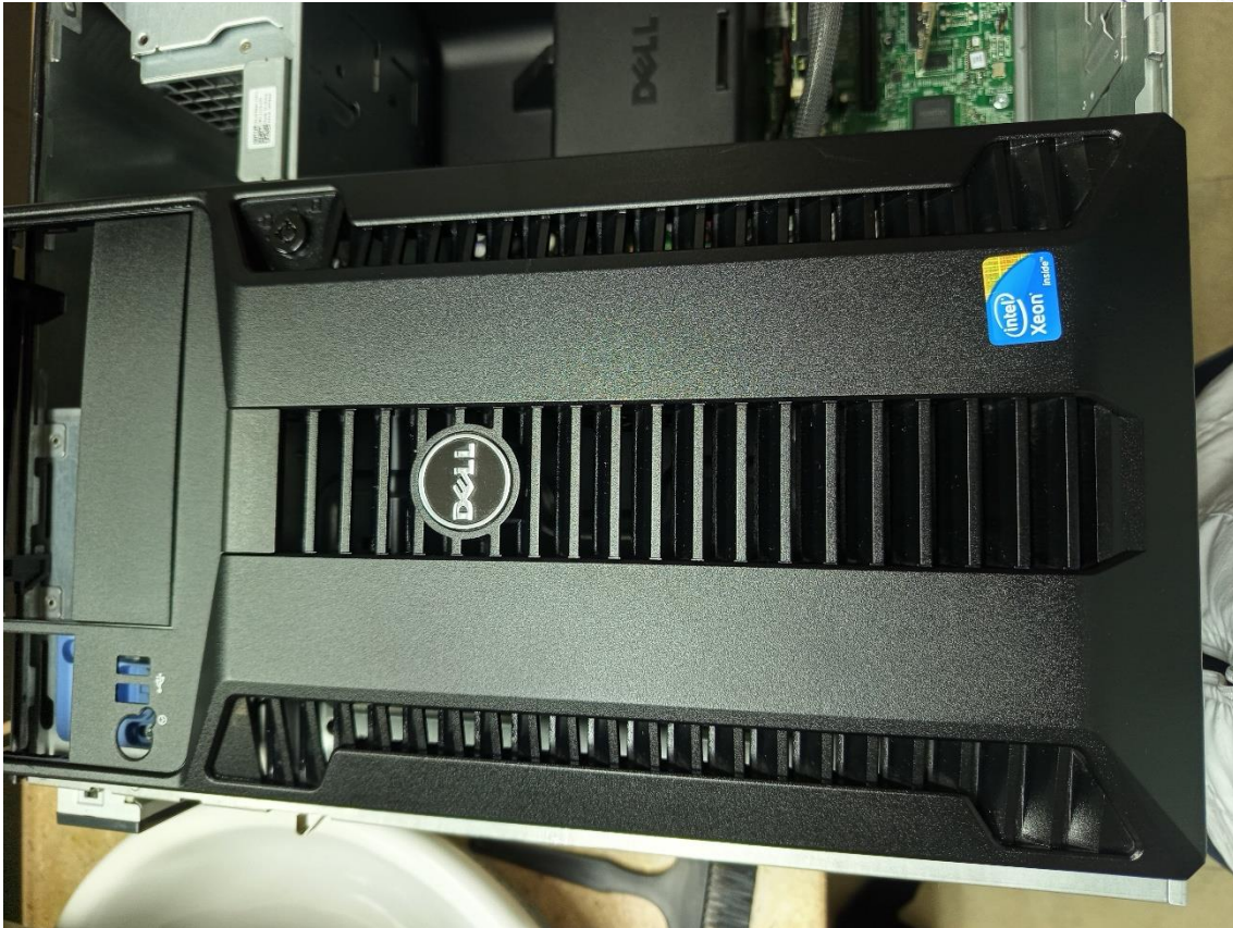
Limpieza de la tapa frontal 1 con químicos especiales no corrosivos.
