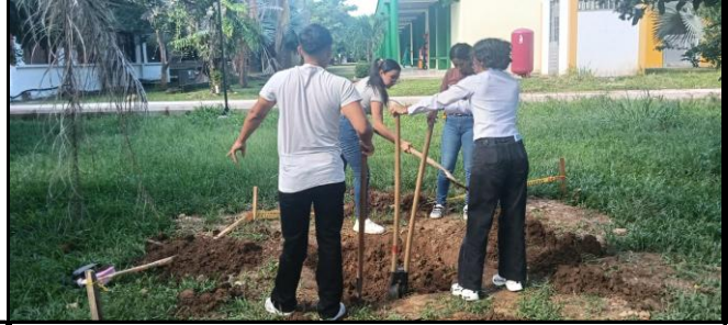
REALIZACION APIQUES PARA ENSAYOS DE LABORATORIO
