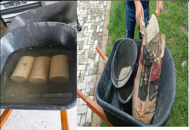
ELABORACION CILINDROS DE CONCRETO, PARA PRACTICAS DE LABORATORIO
