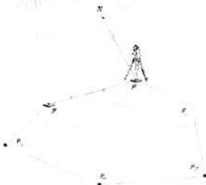
Esquema de una poligonal cerrada
