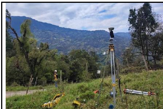
Fotografía 3: Georreferenciación punto de control GPS 3F
