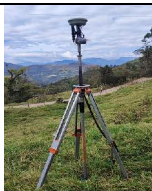
Fotografía 4: Georreferenciación punto de control GPS 4F
