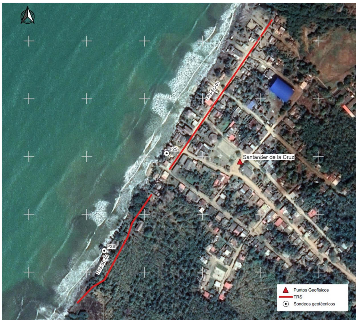
Figura 5.6 Líneas de Refracción Sísmica (TRS), sector Santander de la Cruz
