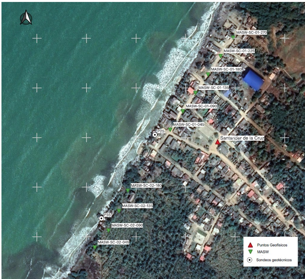
Figura 5.7 Puntos Para Análisis de Ondas Superficiales (MASW), sector Santander de la Cruz.
