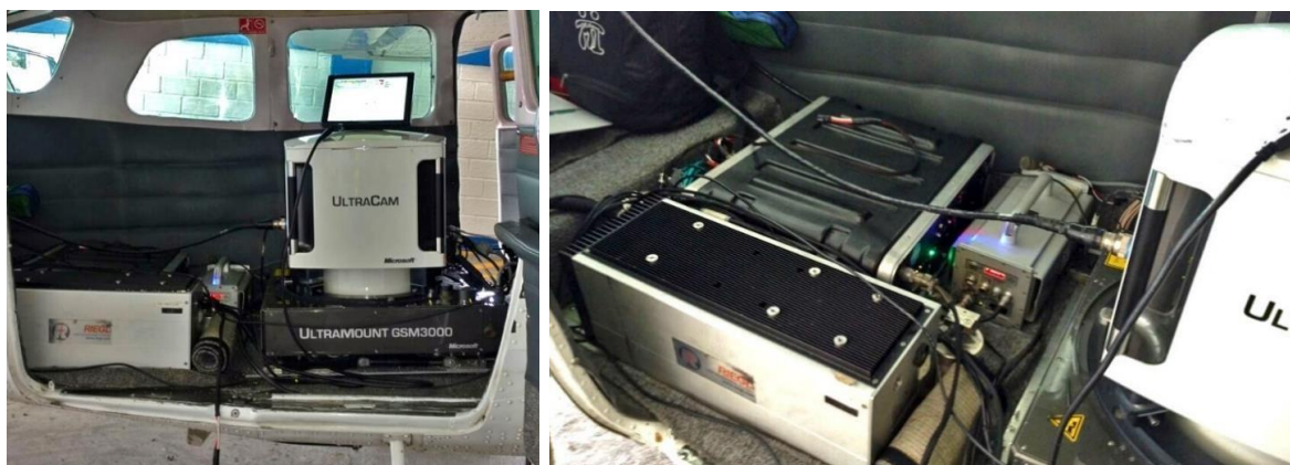
Fotografía 5.2 Lidar RIEGL LMS-Q 560 Y Cámara Vexcel Ultracam LP, instalada sobre la base giroestabilizada UltraMount GSG 3000
