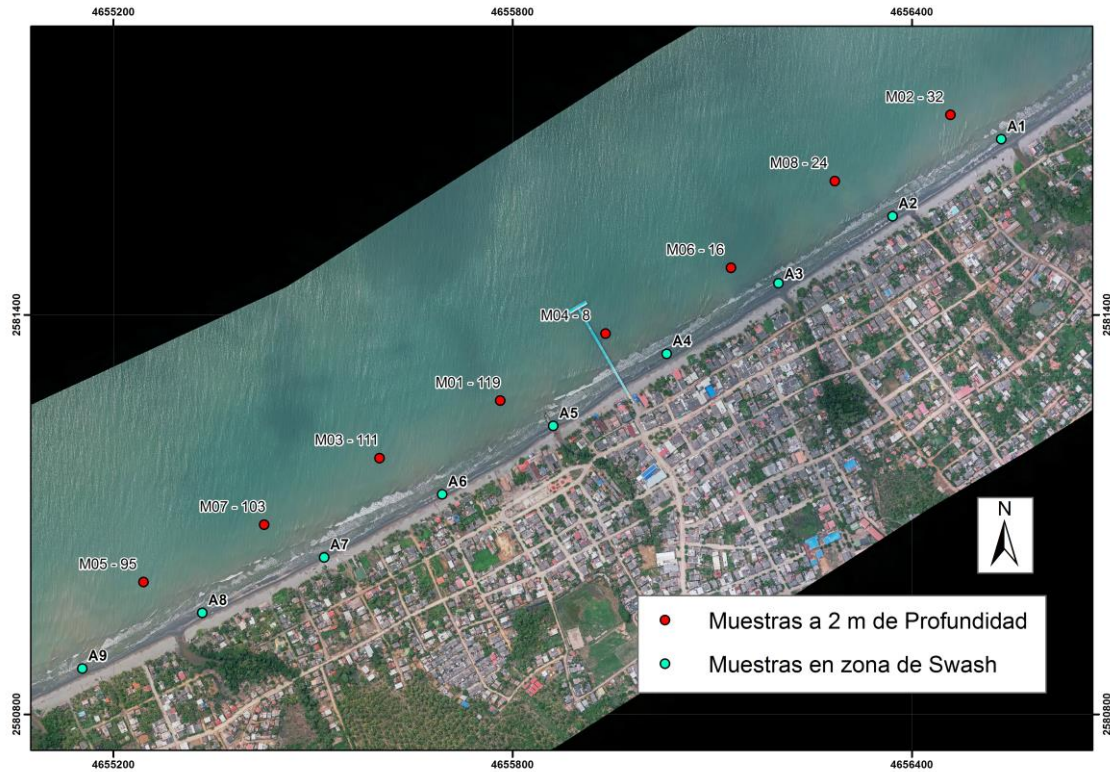
Figura 7.2 Ubicación de toma de muestras a 2 metros de profundidad vs en zona de Swash
