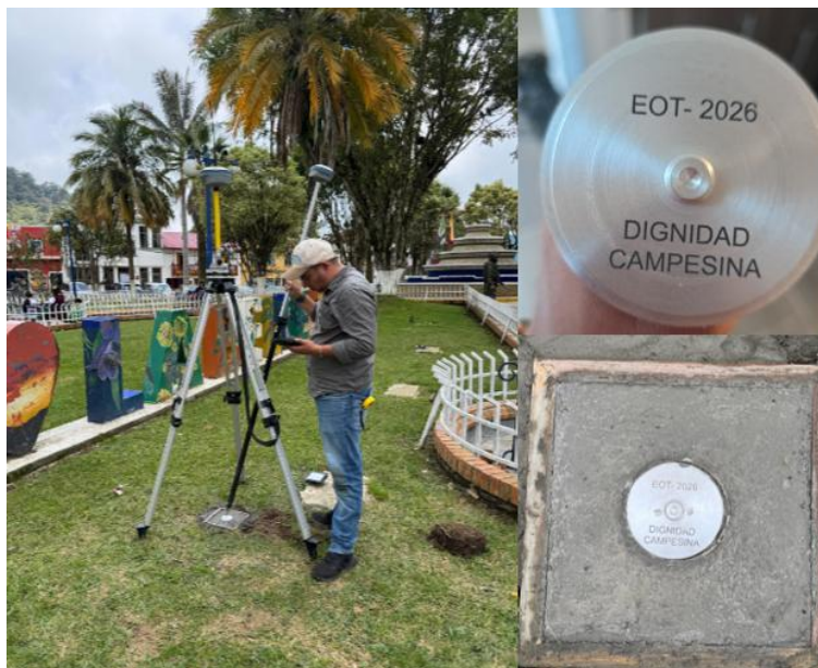
Figura 63: Levantamiento mediante Rtk y amojonamiento aéreas del casco urbano y centros poblados.
