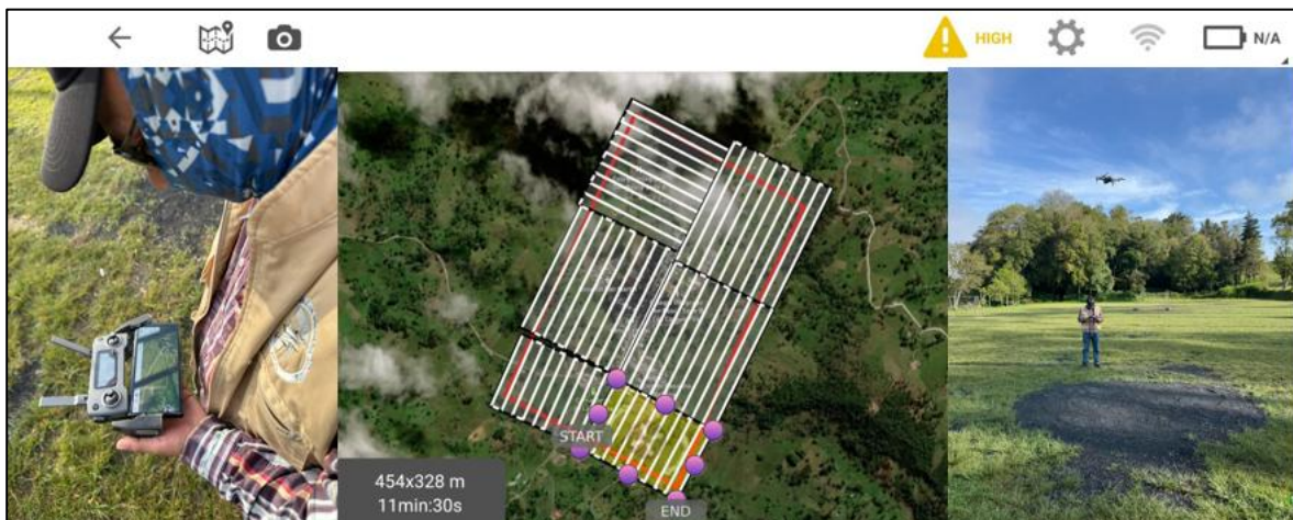
Figura 32: Se observa la realización de topografía y de la actualización de fotografías aéreas del casco urbano y centros poblados.
