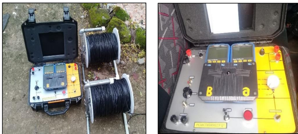
FIGURA 4. EQUIPO DE GEOELÉCTRICA DE RESISTIVIDAD FUENTE: PERCONSA S.A.S, 2026.
