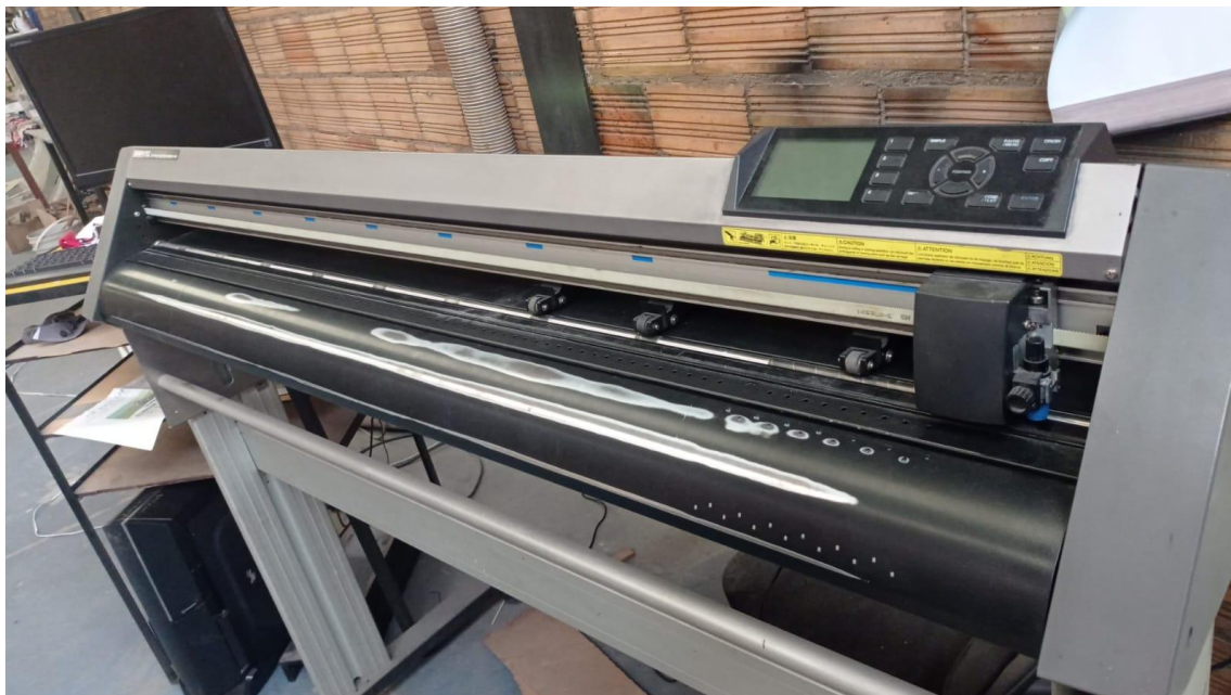
Equipo Plotter de Corte Graphtec CE6000-120 durante labores de mantenimiento correctivo y puesta en marcha.
