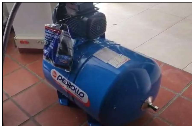
EQUIPO HIDRONEUMÁTICO PARA LA DT PUTUMAYO
