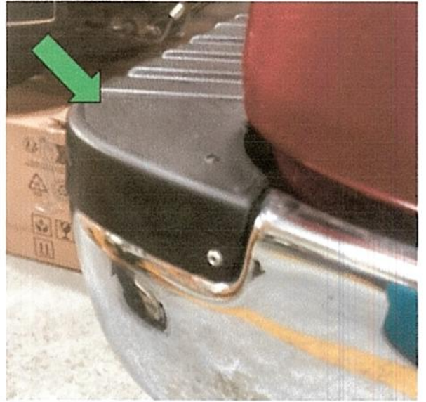
Ajuste de moldura bumper
