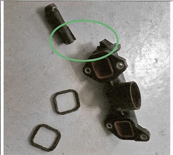
Cambio de tubo de refrigeración, bomba de agua y empaques
