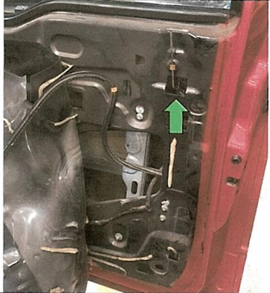
Acople de varilla en la puerta del pasajero fuera de su posición
