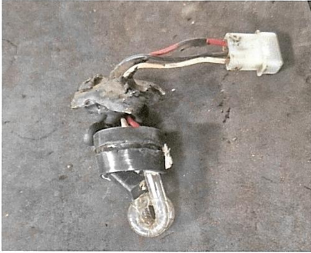
Fallo en el circuito interno de luz strober
