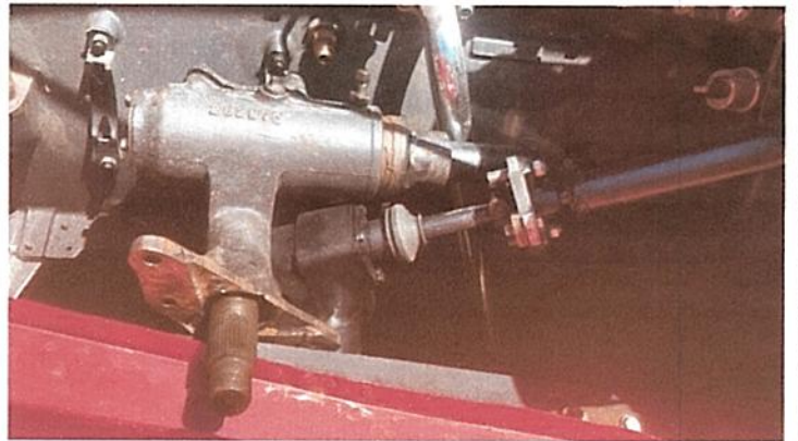
Desmote de la caja de dirección para inspección técnica y diagnóstico general
