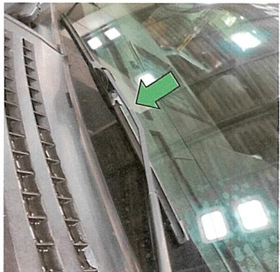
Desgaste en material de barrido de las plumillas por exposición al medio ambiente
