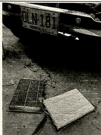
Cambio de filtro de aire motor por contaminación
