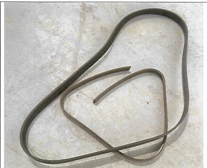
Cristalización y agrietamiento en las correas de accesorios
