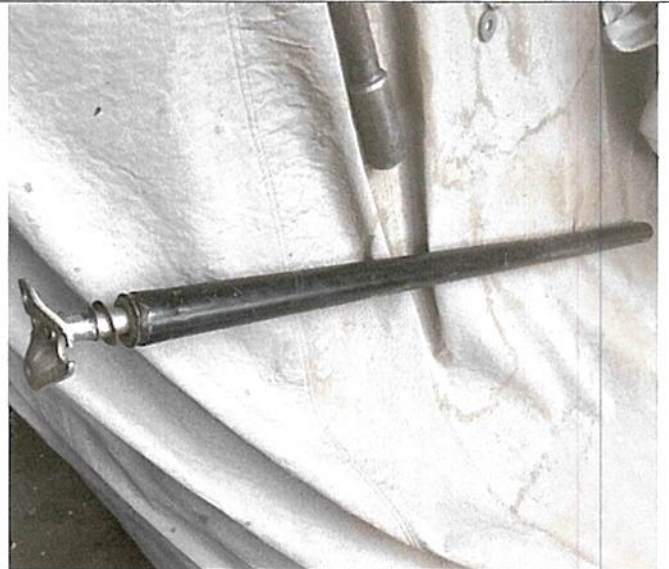
Desmonte de barra de dirección para inspección técnica.
