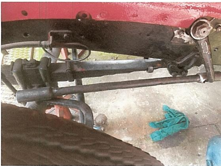
Lubricación general de la suspensión trasera
