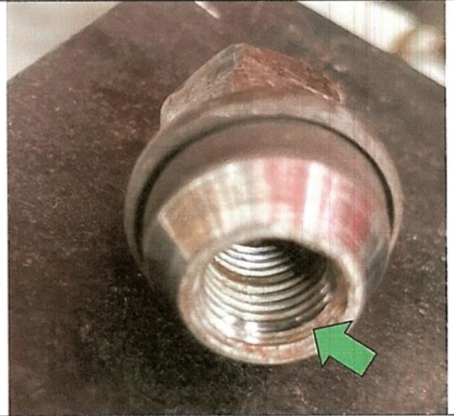
Se evidencia desgaste y deformación de los filetes de la rosca interna de la tuerca
