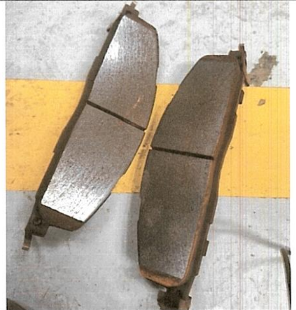
Rectificación superficial del material de fricción en las pastillas delanteras
