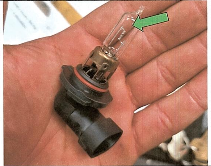
Cambio de bombillo luz farola por apertura en el filamento de iluminación
