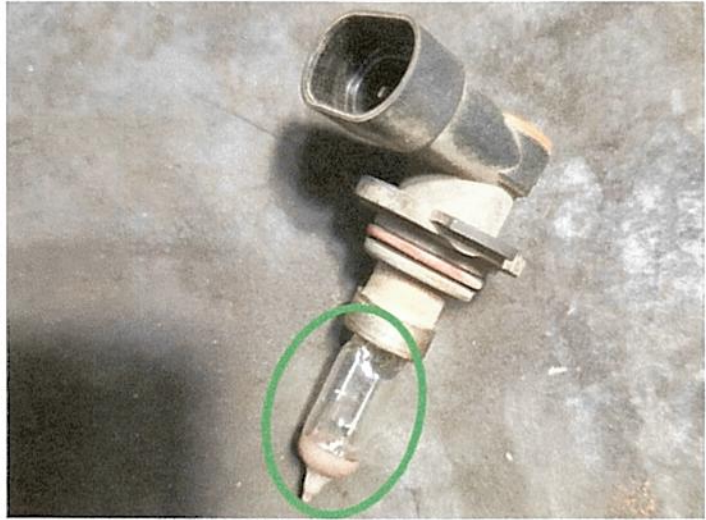
Filamento de luz farola abierto
