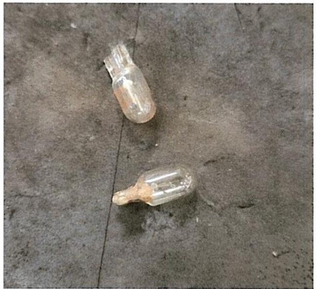
Filamento de luz de placa abierto
