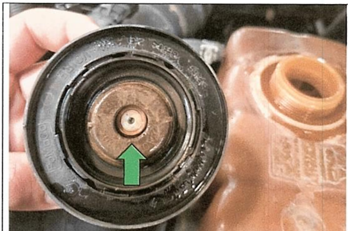
Fallo en la válvula check de presión de la tapa del depósito de refrigerante
