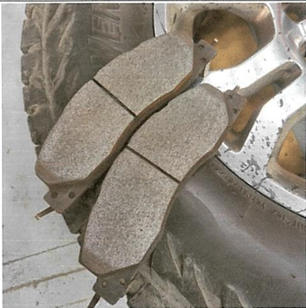
Rectificación superficial del material de fricción en las pastillas traseras
