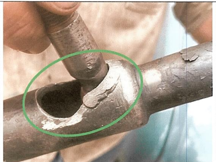
Desgaste en el punto de anclaje entre la caja de dirección y la columna de dirección.
