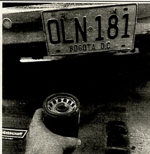
Se realiza cambio de filtro de aceite por rutina de mantenimiento
