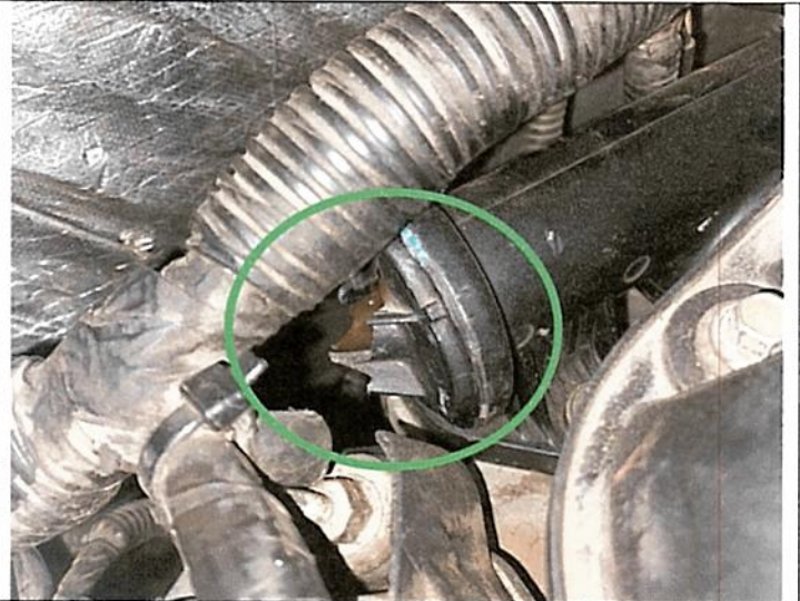
Fuga de refrigerante por ruptura en el tubo de refrigeración de las culatas
