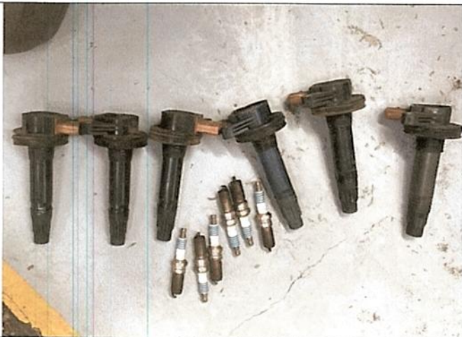
Fallos de cilindros del motor ocasionados por falta de chispa de bobina y bujías
