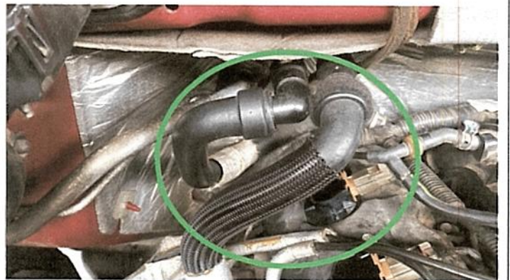
Reemplazo mangueras de calefacción
