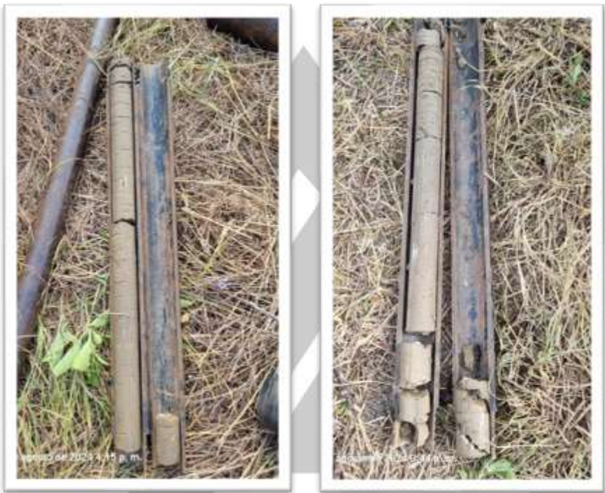
Imagen 4. Perfil estratigráfico de exploración geotécnica
