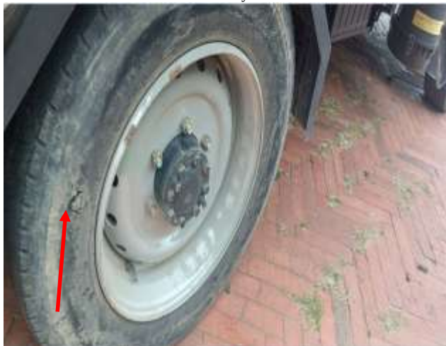
Fotos No. 5: Cambio de llantas traseras y delanteras medidas: 205/75R17
