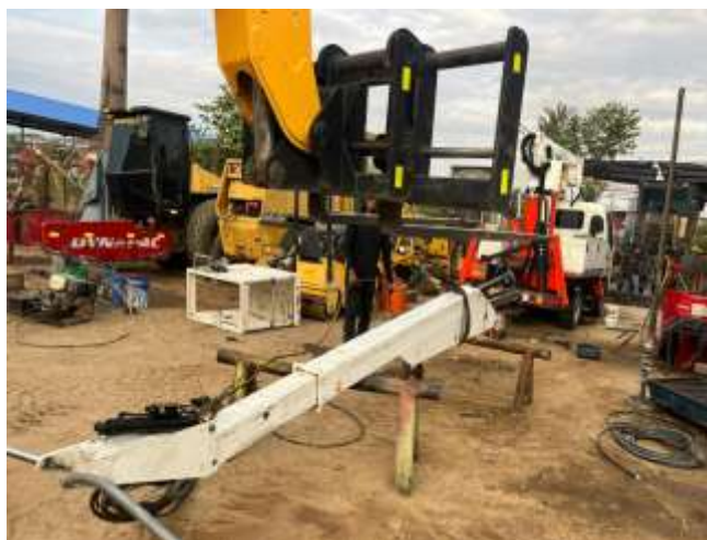
Fotos No. 4: Se realizó reparaciones hidráulicas con el cambio de mangueras hidráulicas dieléctricas de alta presión de diámetro 3/8", 1/4" y 3/16"
