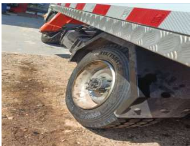
Fotos No. 6: Cambió kit de rodamientos rueda derecha trasera
