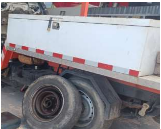
Fotos No. 6: Cambió kit de rodamientos rueda derecha trasera
