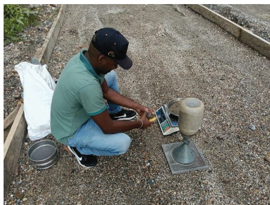
FOTO 03: Toma de densidades método del cono de arena
