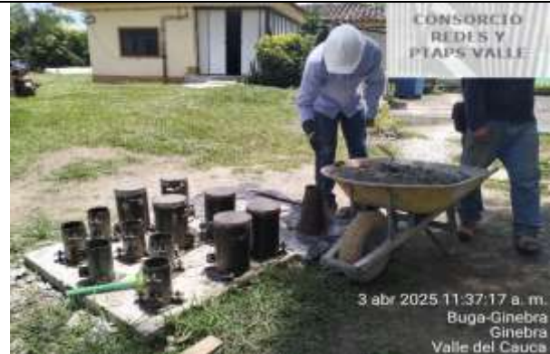
Fotografía 16. Se toman las muestras de calidad del concreto para determinar la resistencia última del concreto.
