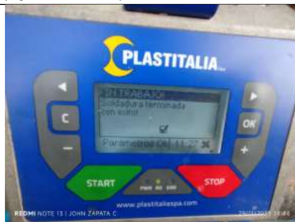
Fotografía 73. Resultado de la pega electro fusión en el sector la Uvalina.
