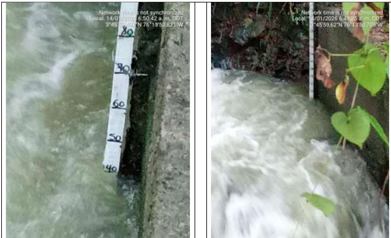
Fotografía. Instalación de niveleta Puente Rojo
