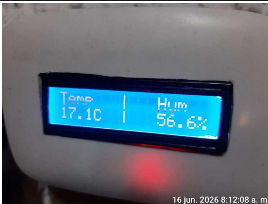
Foto 11. Detalle de lectura de humedad relativa de 56.6% y temperatura de 17.1°C para soporte papel durante la visita del 16 de junio de 2026, la cual está acorde con lo indicado en el numeral 4.1. del Anexo del contrato.
