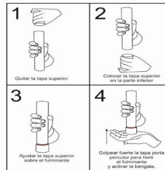
Figura 4. Sistema de activación por percusión
