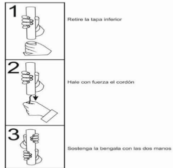
Figura 3. Sistema de activación por tracción
