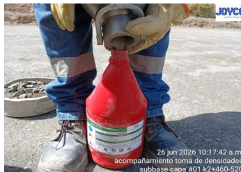
Manajeo y disposición adecuado de Carburo de Calcio (Toma de densidades)
