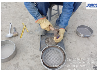
Manajeo y disposición adecuado de Carburo de Calcio (Toma de densidades)
