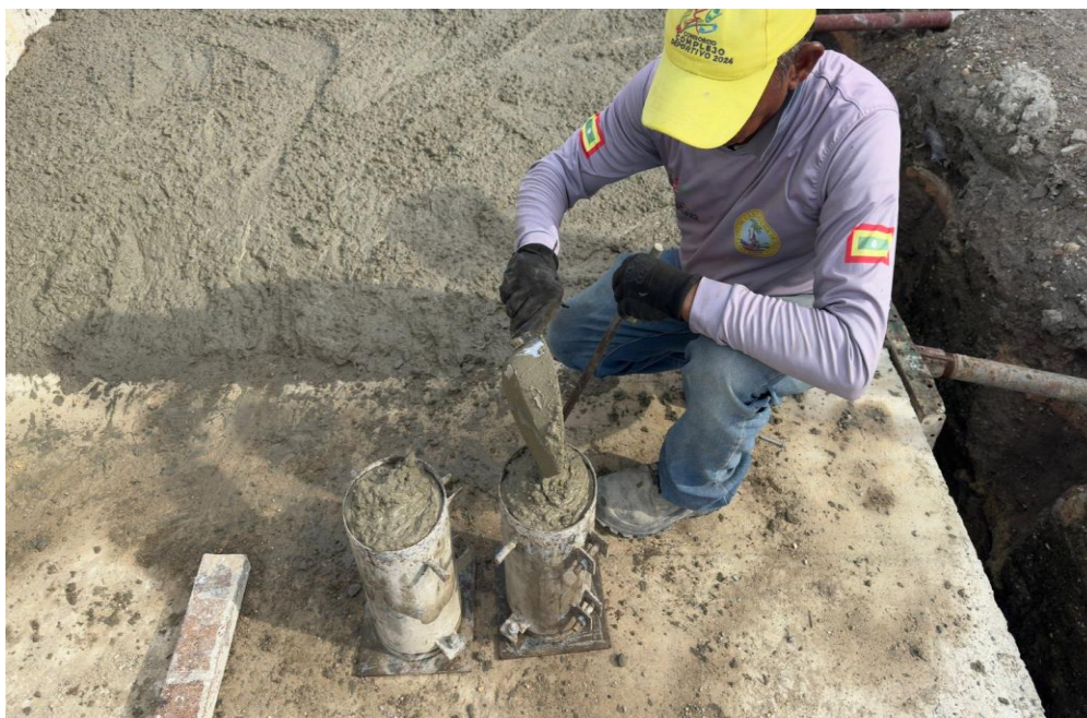
Ilustración 48. Toma de muestras concreto 4000 psi para cimentación acceso Mall plaza ligas mayores
