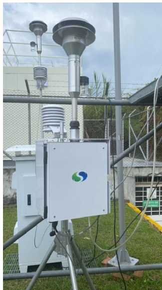
Fotografía: Un (1) equipo automático portable de medición de partículas menores de 10 micras pm-10 con sistema controlador de flujo volumétrico de atenuación beta BAM 1020.
