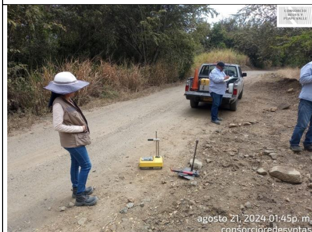
Fotografía 47. Toma de densidades en el Tramo 3 entre la hacienda la Esmeralda hasta la hacienda la Lorena.
