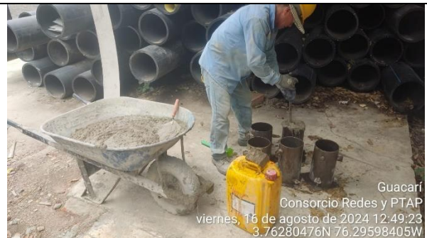
Fotografía 24. Se toman muestras para enviar al laboratorio de las fundiciones realizadas en ambas plantas.
