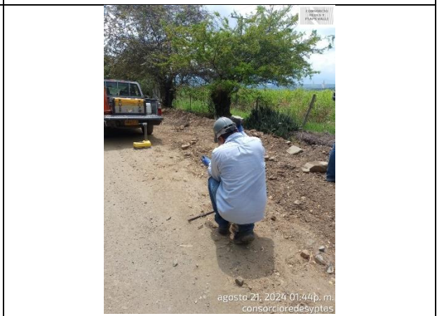
Fotografía 46. Toma de densidades en el Tramo 3 entre la hacienda la Esmeralda hasta la hacienda la Lorena.
