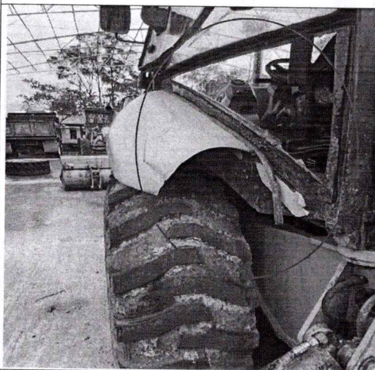
MAL ESTADO DE GUARDA FANGOS
