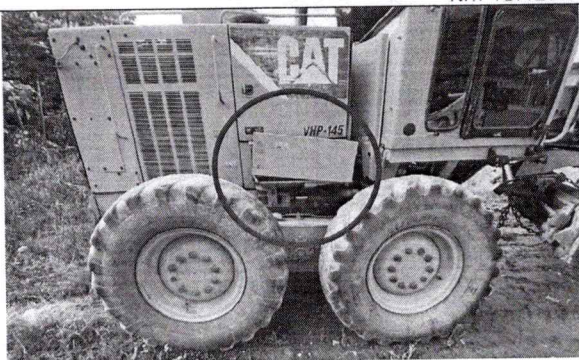
MAL ESTADO DE LATONERIA Y PINTURA
