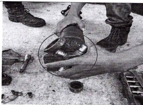
CAMBIO DE OREJAS DE CARDAN MEJORADA CON SOLDADURA REVESTIDA PARA MEJOR TRACCION
