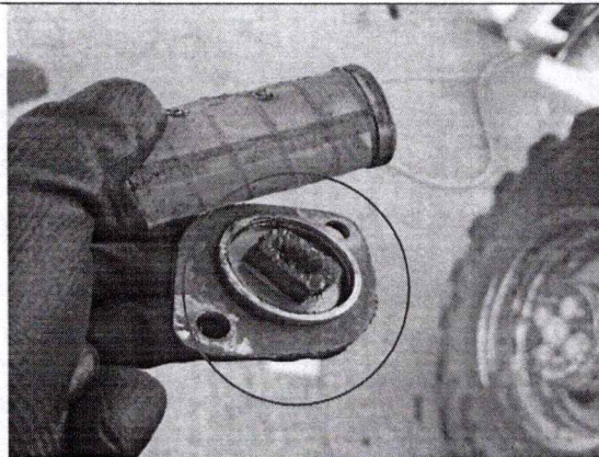
VIRUTA DE FILTRO / DAÑO EN SERVOTRANSMISION
