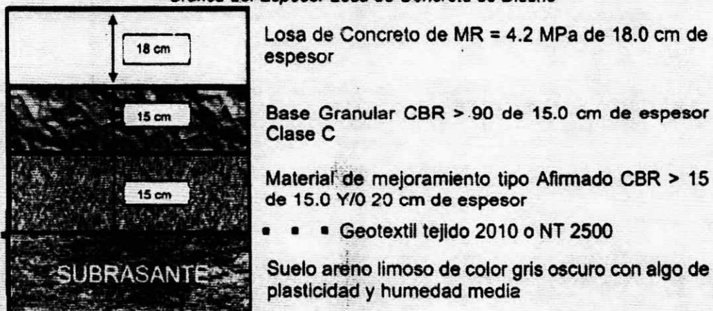
Gráfica 25. Espesor Losa de Concreto de Diseño
