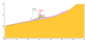
FIGURA No. 144 K7+969.5 CON OBRAS SIN AGUA SIN SISMO
