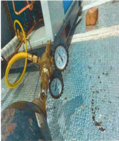
Figura 21- Página 30- Pruebas de presurización del sistema.
