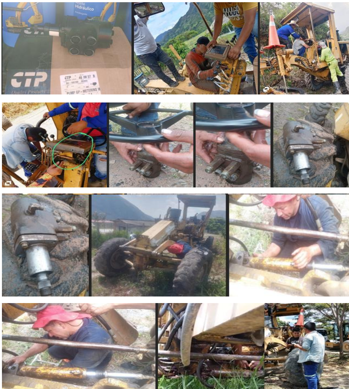
Suministro y reemplazo de manguera del sistema de la dirección.
