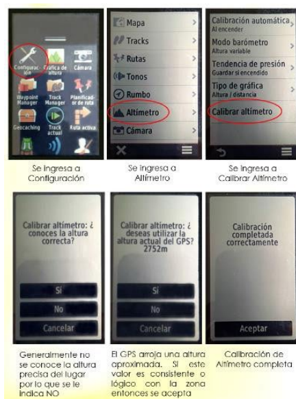
Imagen 2 Calibración de altímetro.
