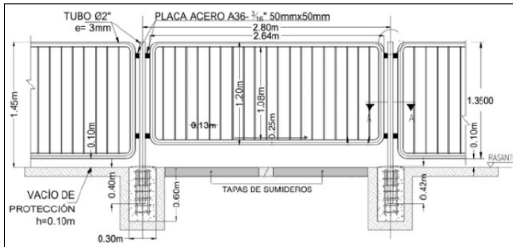
Ilustración 59. Detalle de vallas
