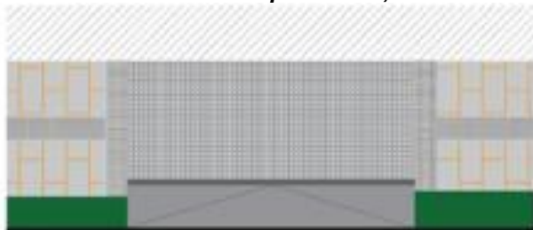
Ilustración 15 Uso Señalización podotáctil, acceso vehicular predio, ancho menor a 5m
