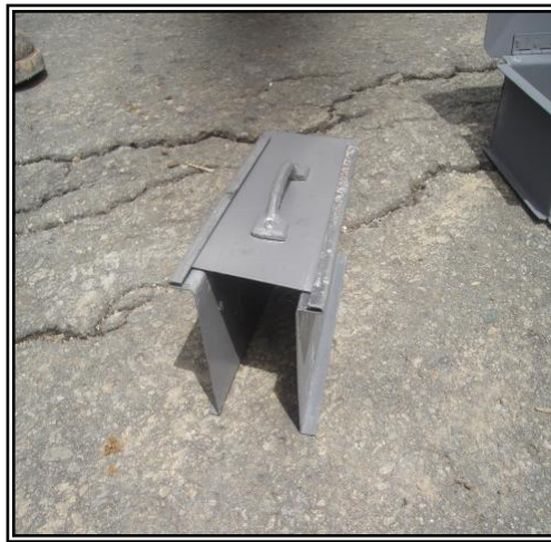
Compuerta de aireación (Oido)
