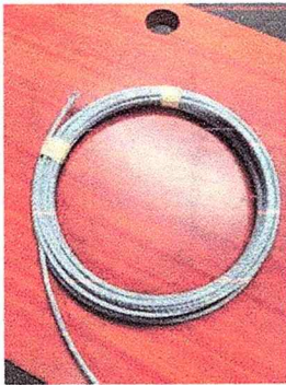
Fotografía 10 Guaya de acero galvanizado
