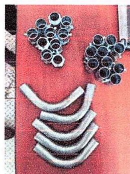
Fotografía 9 Conectores y curvas conduit EMT 1"
