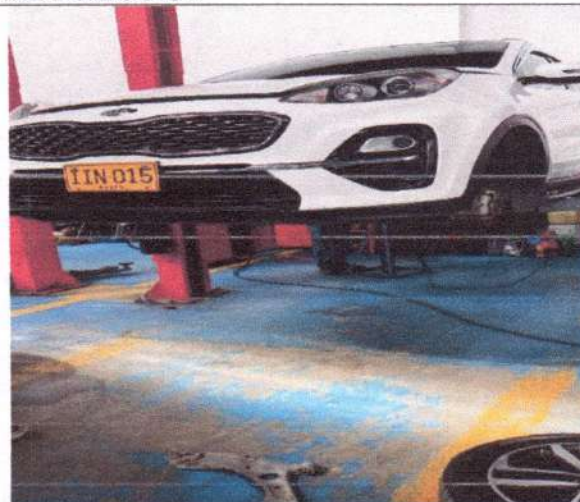
112. REVISION Y AJUSTE TORQUE SUSPENSION
