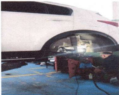
139. MANTENIMIENTO FRENO: DESARME, LIMPIEZA, REEMPLAZO DE PIEZAS, ARMADO DE FRENO 4 (RUEDAS)
